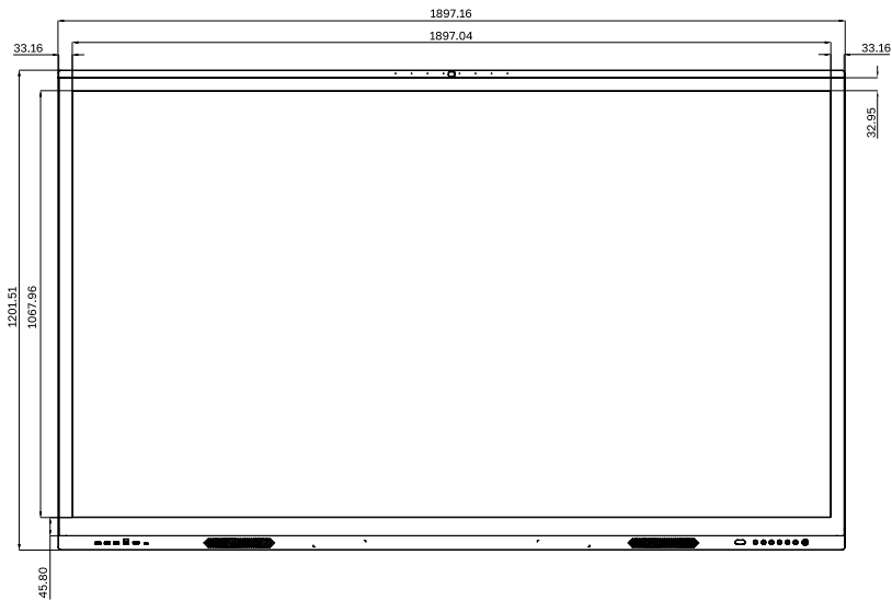
СХЕМА ПАНЕЛИ (ВИД СПЕРЕДИ)
